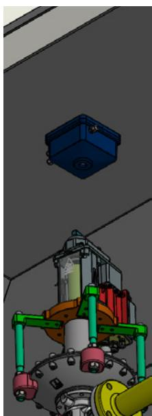
Il dispositivo integra un sensore di CH<sub>4</sub> in grado di **rilevare le concentrazioni in ppm** e di convertirle in **emissioni espresse in kg/anno**, in linea con i requisiti normativi. Grazie al design compatto e all'installazione in zona ATEX 0 (metano e idrogeno), **MethanEye** può essere posizionato direttamente in prossimità della fonte, intercettando anche le **perdite difficilmente accessibili**.
